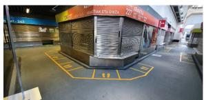
Con posterioridad, se realizó esta misma señalización con **pintura amarilla** en el suelo en el **Mercado de La Ribera** dado que las bandas colocadas inicialmente no resistieron el uso intensivo del Mercado ni el empleo de medios mecánicos empleados en la limpieza de los suelos.
